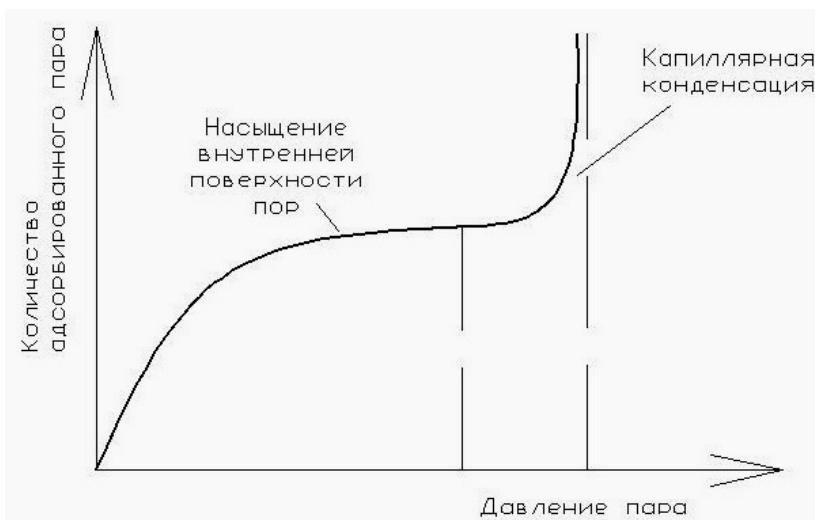
Рис. 5.5. Изотерма адсорбции (относительная влажность воздуха при постоянной температуре)
