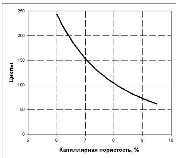
Рис. 5.6. Зависимость морозостойкости бетона от капиллярной пористости
