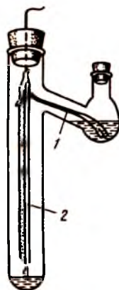
Рис. 8.39. Прибор для получения нисходящей хроматограммы на закрепленном слое:
