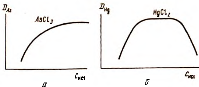
Рис. 7.5. Зависимость коэффициента распределения As(III) (а) и Hg(II) (б) от концентрации соляной кислоты при извлечении инертными органическими растворителями
