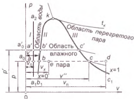
Рис. 10.6. Процесс парообразования в p-v -диаграмме
