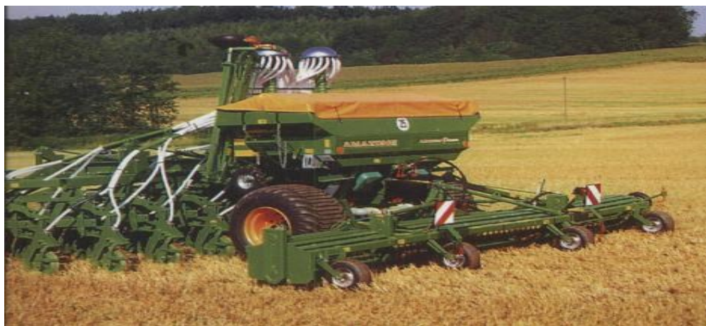
Рис. 36. Универсальная высокопроизводительная пневматическая сеялка прямого посева «DMC Airstar Primera»
