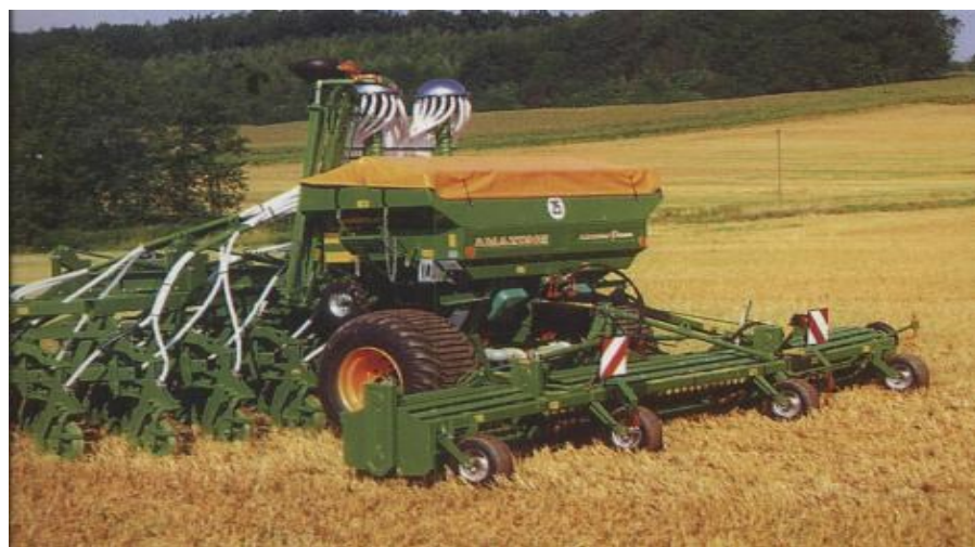
Рис. 28. Универсальная высокопроизводительная пневматическая сеялка прямого посева «DMC Airstar Primera» (Amazone)
