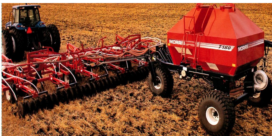
Рис. 32. Пневматическая сеялка-культиватор Morris Concept-2000
