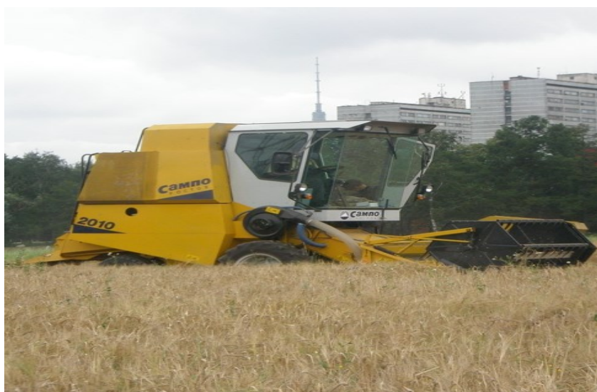
Рис. 37. Уборка ячменя самоходным комбайном «Сампо» с использованием электронной карты урожайности
