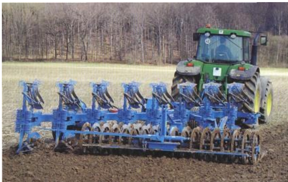
Рис. 24 Полунавесной оборотный плуг Vari-Diamant в агрегате с катками
