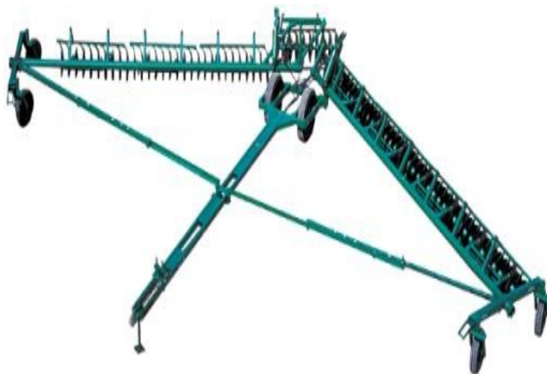
Рис. 19 Луцильник дисковый гидрофицированный ЛДГ-10Б
