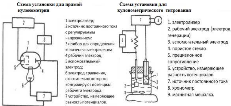
Рис. 12. Схема установки в кулонометрии
