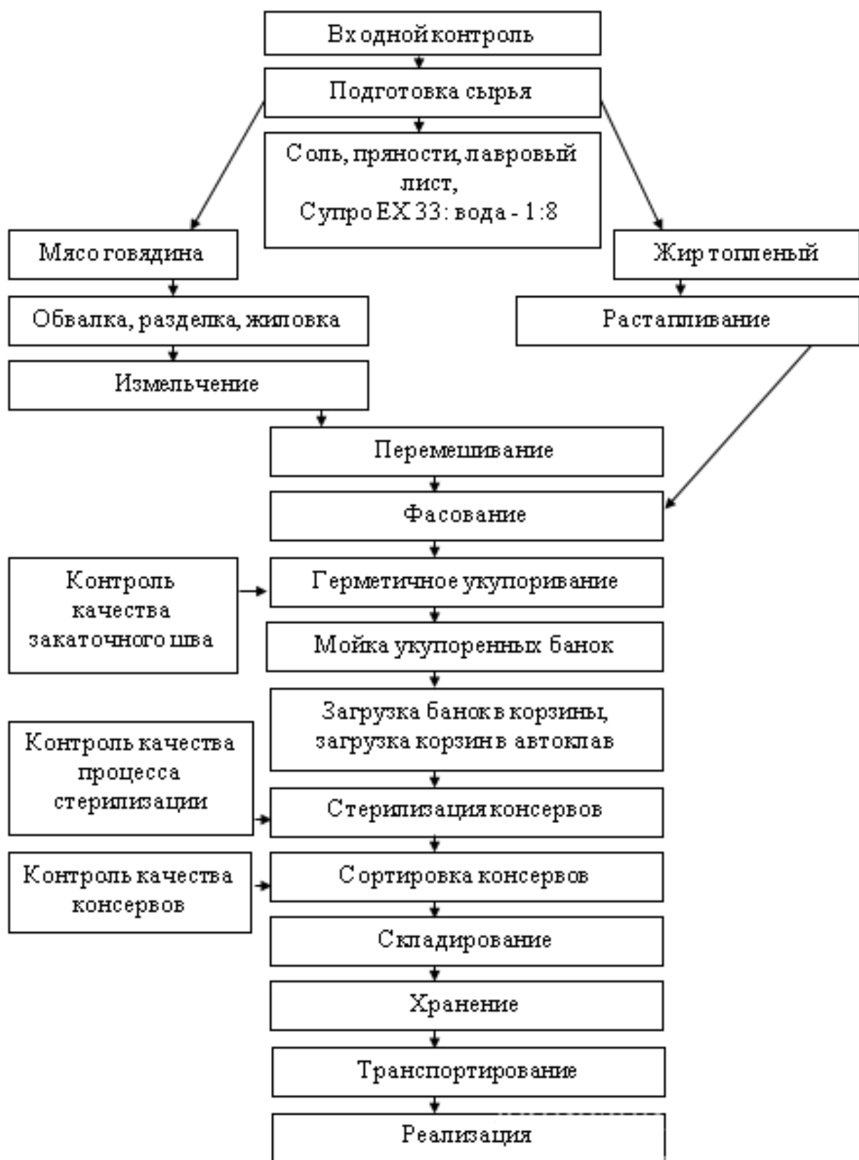
Рисунок 78 – Технологическая схема производства мясных консервов «Паитет для завтрака с мясом»
