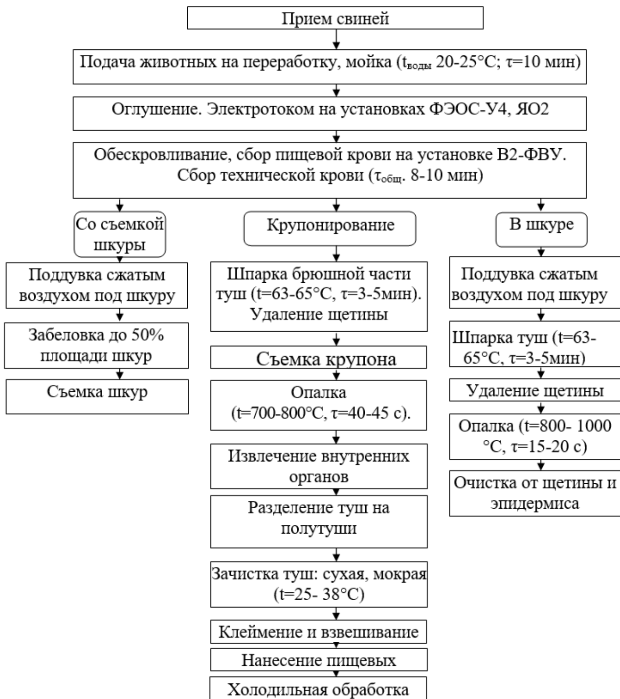
Рисунок 5 – Технологическая схема переработки свиней
