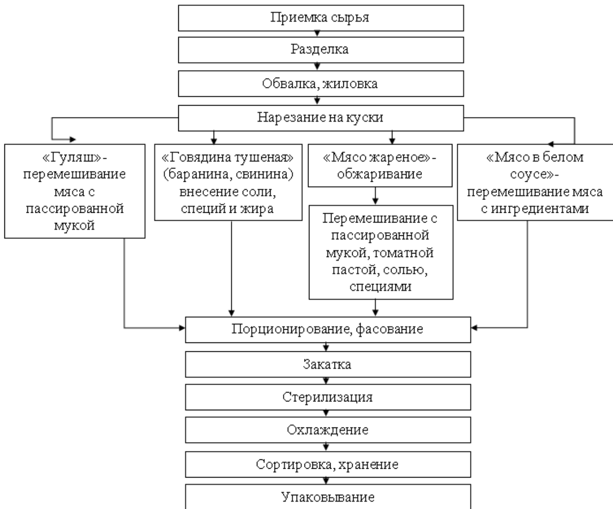
Рисунок 73 – Технологический процесс производства натурально-кусковых консервов
