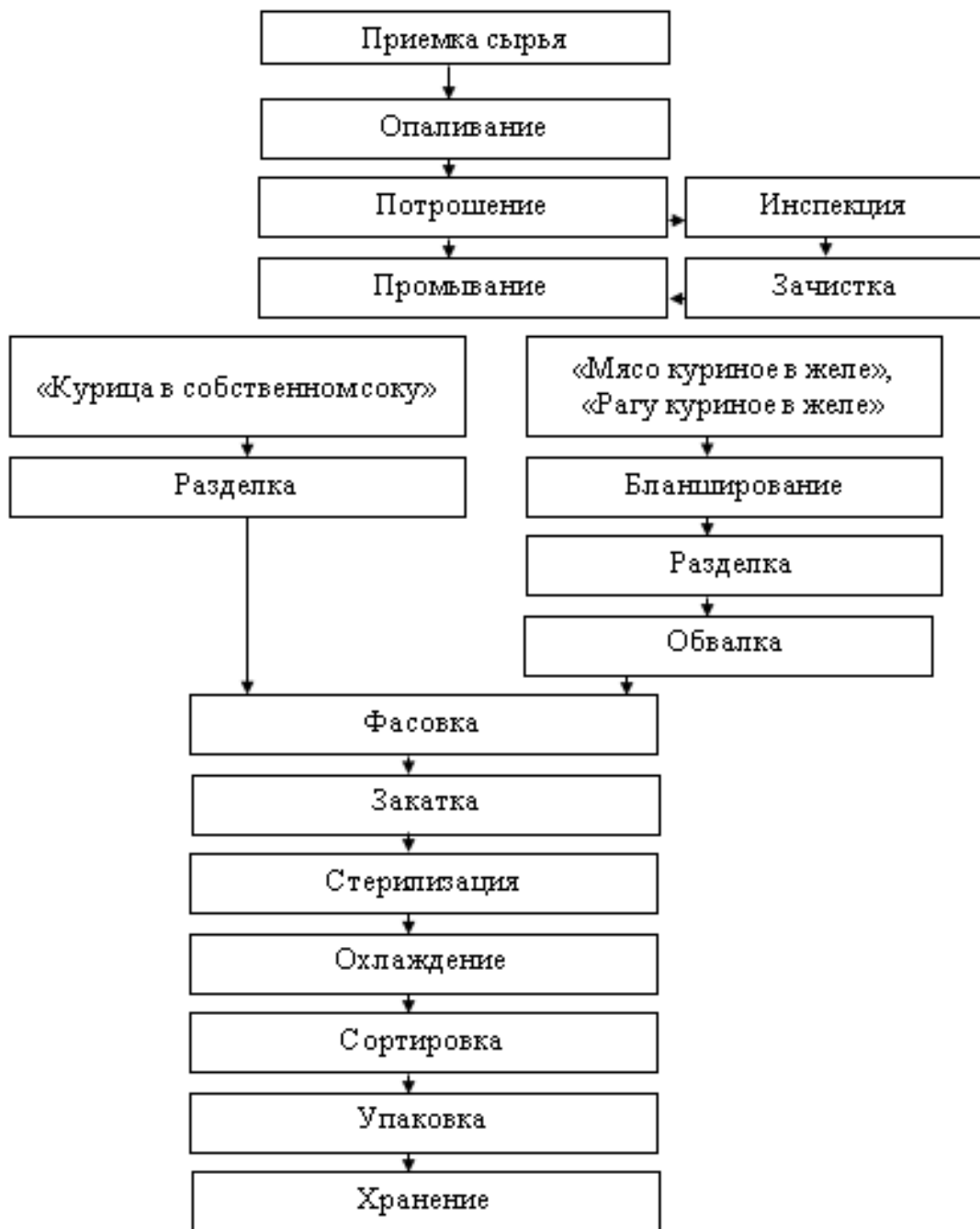
Рисунок 76 – Технологический процесс производства консервов из мяса птицы
