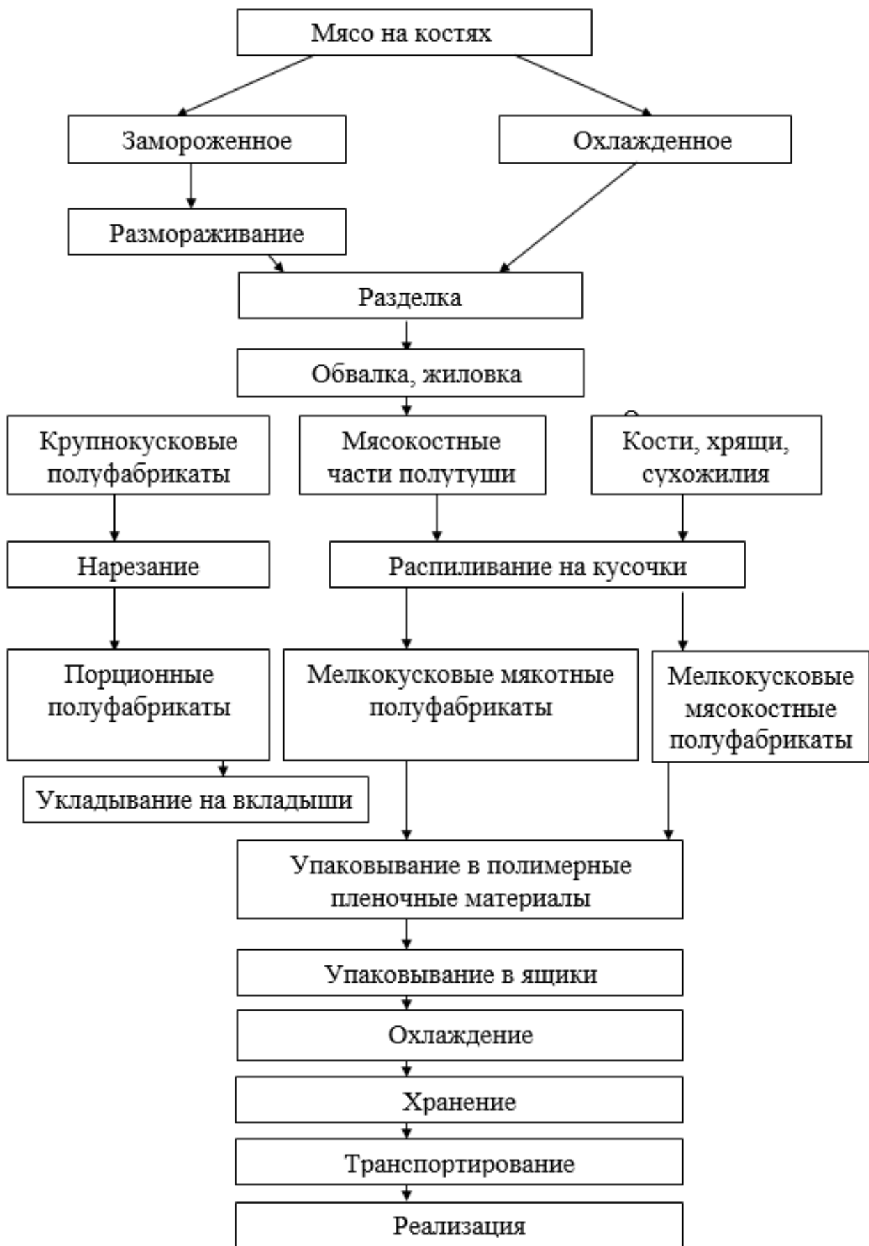
Рисунок 47 – Технологическая схема производства порционных и мелкокусковых мясных полуфабрикатов
