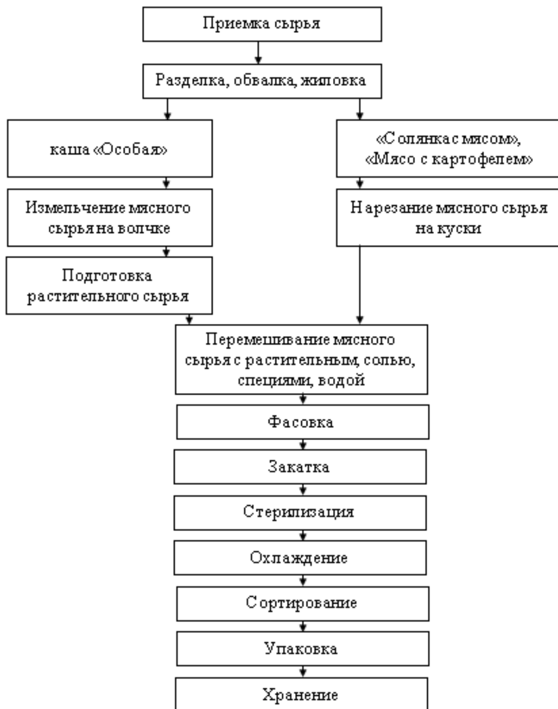
Рисунок 74 – Технологический процесс производства мясорастительных консервов
