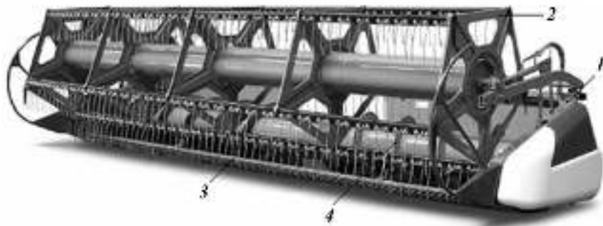
1 – корпус; 2 – мотовило; 3 – аппарат режущий; 4 – шнек
